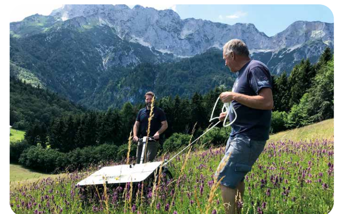
Um regionales Saatgut zu erhalten, werden Wiesen mit dem Erntegerät „eBeetle“ schonend ausgeburstet.
